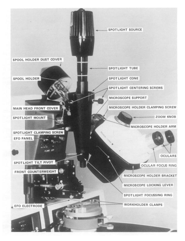
FIGURE 3-2 MODEL 4124 BALL BONDER - FRONT PARTS
