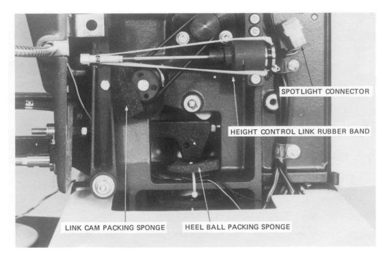
FIG. 5-4 MAIN HEAD PACKAGING - INNER RIGHT SIDE
