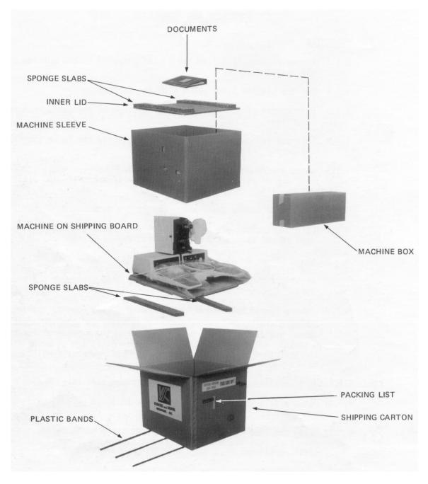
FIG. 5-1 BONDER PACKAGING - EXPLODED VIEW
