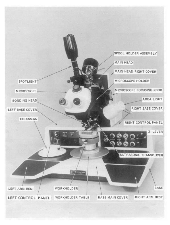
FIGURE 3-1 MODEL 4124 BALL BONDER - MAIN PARTS
