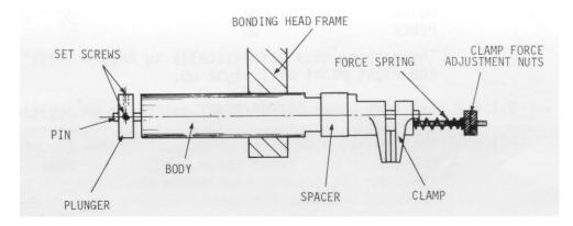
FIG. 6-4 WIRE CLAMP SOLENOID
